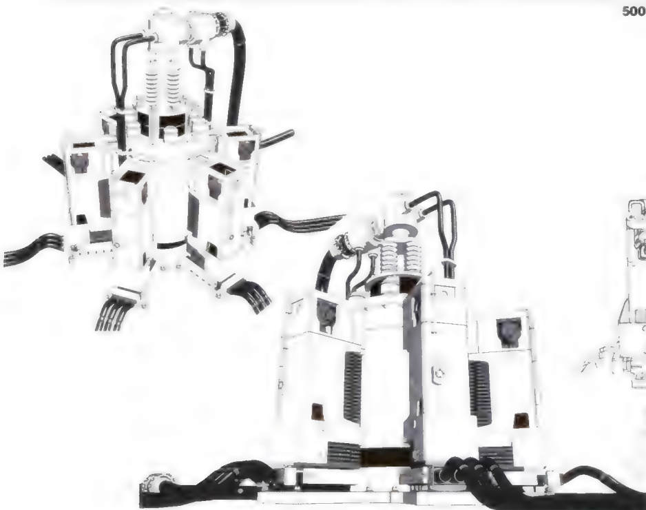
同・第5及び6段設備 超伝導 500kV 大容量電力貯蔵装置 (SMES) 3DCG モデル
